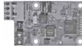
Fig. 23 Módulo de interfaz de comunicación Grundfos CIM
