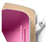
**Reducción de las pérdidas de calor hasta un 16%** debido a la tecnología de aislamiento INSUTECH y a la ausencia de puente térmico, que se elimina gracias al acople de la placa de montaje a la carcasa del termo y no al tanque interior.
